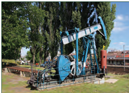
Dva druhy těžebních kozlíků - povrchových částí hlubinných (pístových) čerpadel, která sloužila k těžbě ropy.
