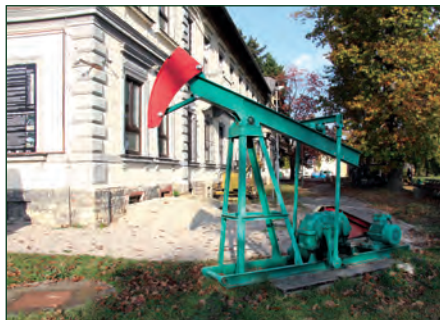
Dva druhy těžebních kozlíků - povrchových částí hlubinných (pístových) čerpadel, která sloužila k těžbě ropy.
